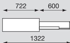
Cassetto con guida telescopica ad estrazione totale portata kg 62
